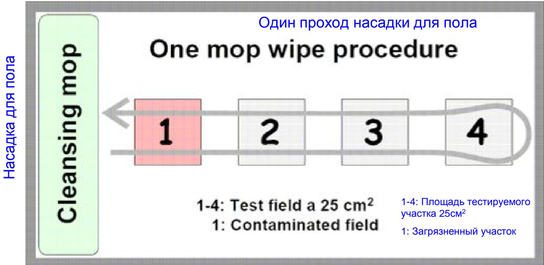
Изображение поверхности для очистки с помощью швабры с тестируемыми участками №1-4.
